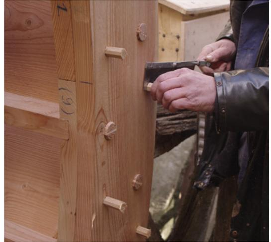
Die Holznägel, durch diese werden die beiden Felgen zusätzlich zusammengehalten, stehen noch über die Fläche des Radkranzes hinaus. Sie werden abgesägt und an die Oberfläche angepasst damit sie mit ihr eine Fläche bilden. *Leon Söllner*
