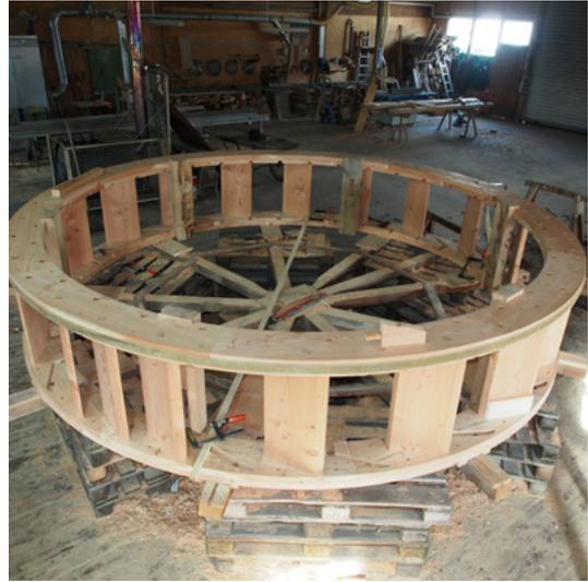
Das Rad ist auf dem Lehrgerüst grob zusammengesteckt: Jeweils zwei Felgenringe bilden einen Radkranz. Zwischen den beiden Radkränzen sind die Setzschaufeln eingepasst. Die Kopfhölzer sind mit Verzapfungen versehen und sitzen an den Positionen, wo später die Speichen eingepasst werden. *Juliane Sander*
