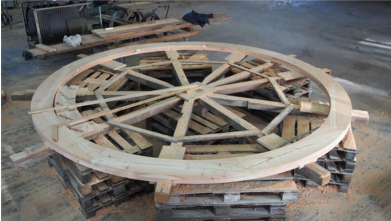
Ein Radkranz besteht aus zwei übereinander lagernden Felgen. Eine Felge wird von neun Segmenten gebildet. Nach dem Ausarbeiten aller 18 Segmente werden sie auf dem Lehrgerüst zusammengepasst. Dabei handelt es sich um eine Hilfskonstruktion, die zur Festigung und Formgebung der Neuanfertigung dient. Mit einem Zirkel, der die Form einer Kammer abbildet, werden auf der Felge 36 Schaufeln in gleichmäßigen Abständen zueinander angebracht, anschließend maximal 25 Millimeter eingestemmt.
