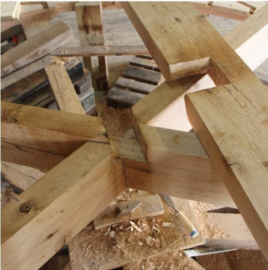
Die drei Speichen sind mittig durch eine Überblattung<sup>15</sup> ineinander verschränkt. Gleichzeitig verbindet sie die Speichen später beim Radaufbau mit dem Wellbaum, der Achse des Wasserrades. *Leon Söllner*
