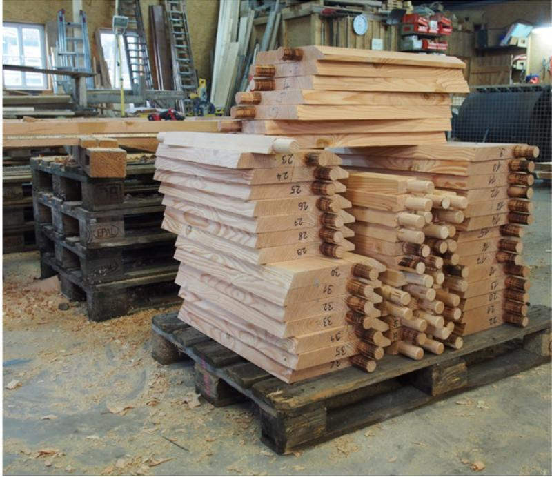
Eine Schaufel besteht aus zwei Hölzern, die in einem bestimmten Winkel zueinander stehen: Das innere, in Richtung Wasserradwelle weisende Holz nennt man „Riegelschaufel“, das äußere Teil „Setzschaufel“.<sup>12</sup> *Leon Söllner*
