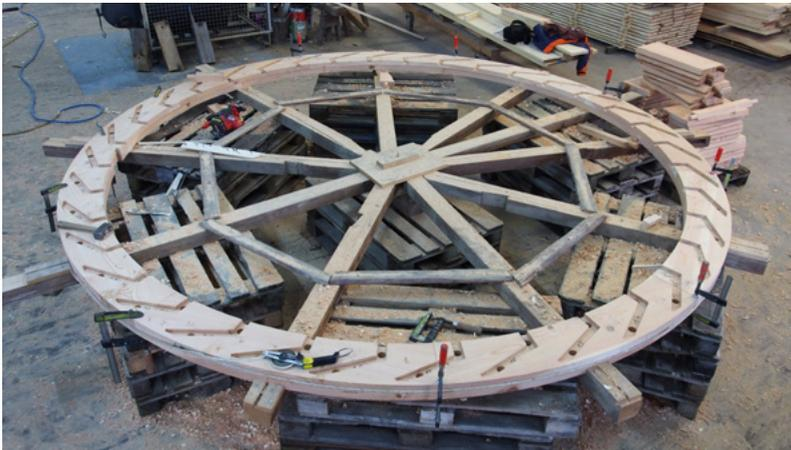
Der erste, innere Radkranz mit den eingestemten Feldern. In diese werden die Löcher für die Zapfen der Schaufelhölzer gebohrt.
